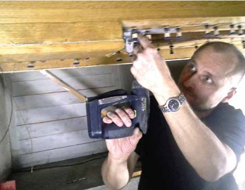
ORGELBYGGJAR I ARBEID: Kyrkjelydsbladet møter Dietrich Johannes Buder i kyrkja ein føremiddag, travelt oppteken med å fjerna dei gamle magnetkontaktane inne i orgelet.
