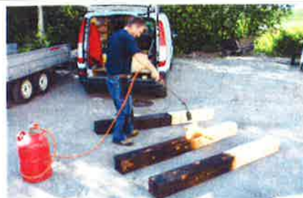
Malmfuru fra Rørås impregnert med sot. gammel impregneringsmetode.
