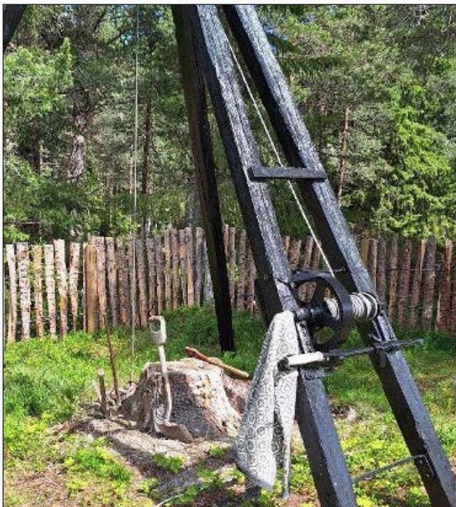
Stubbebryter som vart nytta til opparbeiding av ny jord på Purkelykkja
