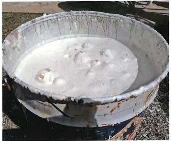
«Koklesking» (våtlesking) av vedbrent kalk til slemming og hvitting.
