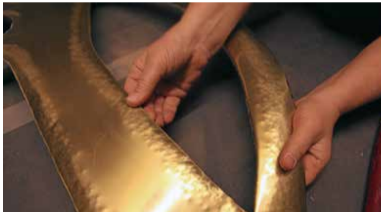
Mariamaljan är gjord i en millimeter tjock mässingsplåt.
