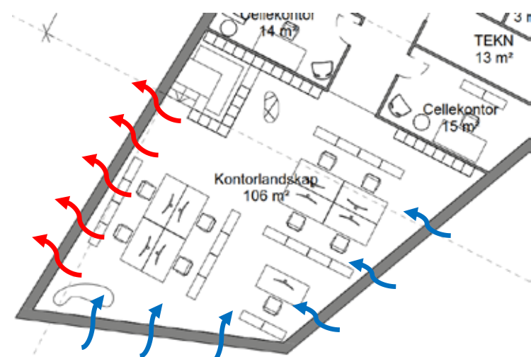
Figur 5: Ventilationsprincip for den naturlige ventilation i kontorlandskabet
